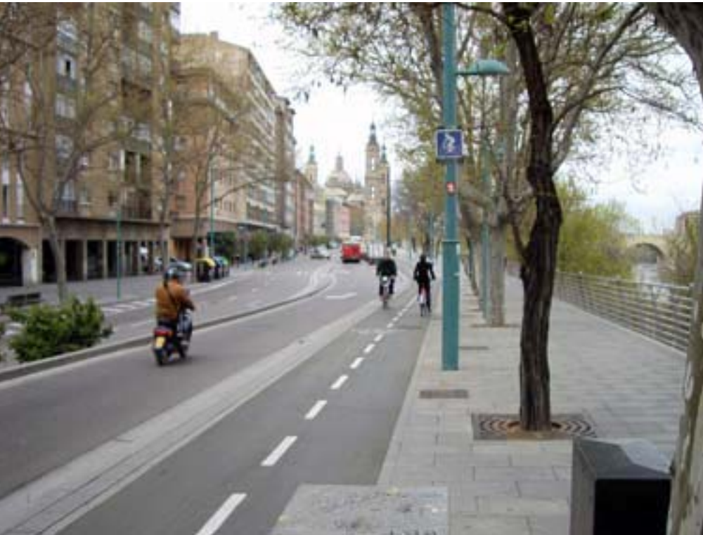
Foto 3: El carril bici ha ocupado un carril de circulación en uno de los sentidos; retirando aparcamientos y ampliando aceras.
